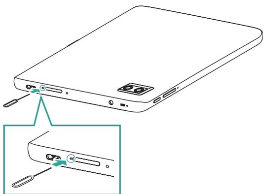
②カードトレイを引き出し、microSD カードの端子面を下にしてカードトレイに置く
